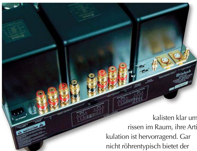
Auch der Rücken kann entzücken: gekapselte Transformatoren und stabile Lautsprecherbuchsen, die sowohl Kabelschuhe wie Bananenstecker aufnehmen. Der MC2102 kann wahlweise symmetrisch angesteuert werden.
