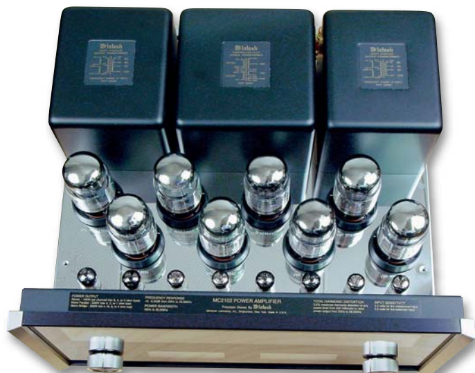
Wer keine kleinen Kinder oder Haustiere berücksichtigen muss, kann den MC2102 auch ohne Röhrenschutzgitter betreiben. So oder so benötigt dieser monumentale Endverstärker einen bevorzugten Platz mit genügend Luft.
